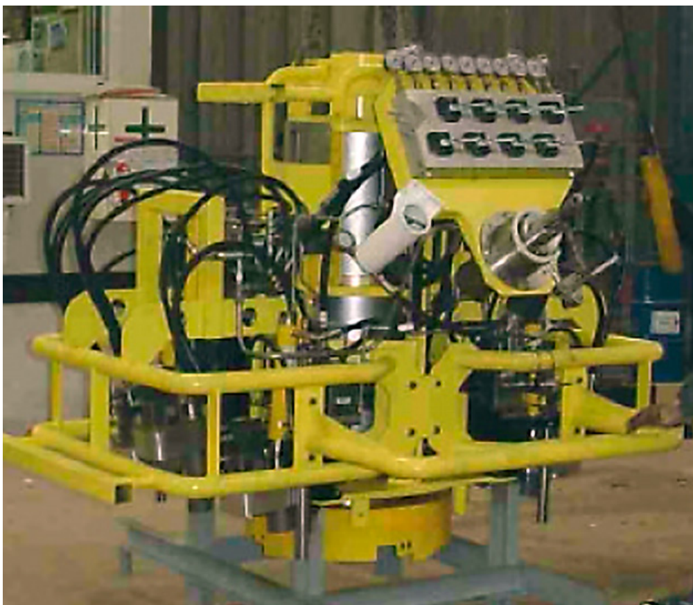
Rysunek 31. Urządzenie hot-tapping zastosowane w przypadku wraku Prestige
