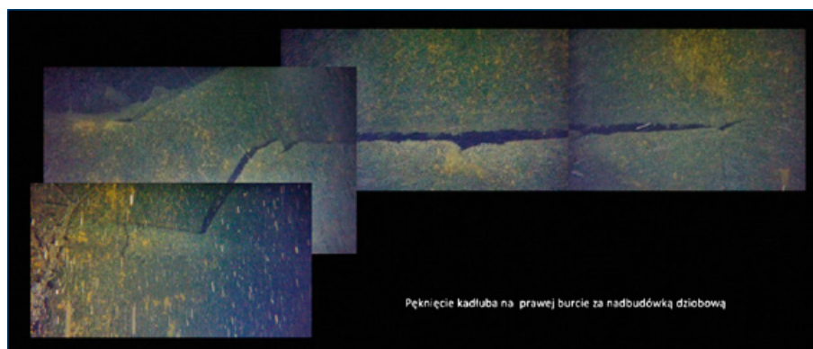
Zdjęcie 25. Mozaika prawej burty pod nadbudówką pokazująca długie na około 10 metrów i szerokie na od 5 do 30 cm pęknięcie kadłuba (źródło: ekspedycja 2018)
