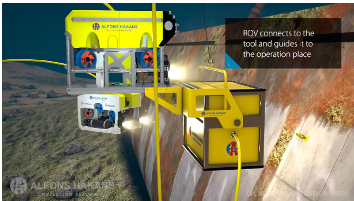
Rysunek 32. ROV z narzędziem hot tapping firmy Alfons Håkans (Estonia and Park Victory cases info 2015-12-08 KR.pdf)
